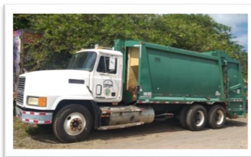
Ilustración 11. Vagoneta tipo prensa que se utiliza cuando se requiere para la recolección de los residuos sólidos
